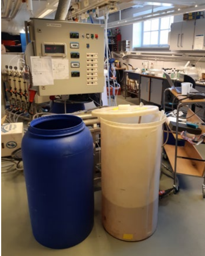
Figur 3-8. Nanofiltreringsanläggning med tankar med permeat och retentat.
